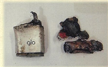
火災の原因と思われる小型充電式電池
