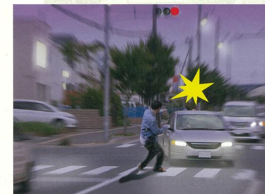
★車のライトは照らせる方向が固定されているため、右・左折するときに側方を照らすことができず、車の側方に横断歩行者・自転車がいてもドライバーに見落とされることがあります。
